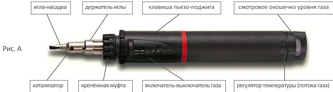
**Шаг 3.** Температуру и поток газа можно регулировать путём поворота регулятора на конце прибора, а также путём своевременного выключения клавиши подачи газа. Для достижения необходимой температуры не требуется накаливать катализатор до красна, достаточно поставить регулятор температуры на средние. После набора необходимой температуры, в т.ч. и во время работы, нужно перекрывать вентиль потока газа сдвигом выключателя газа, чтобы не допускать подгорание расплавляемого материала.
