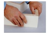
**Шаг 3.** Плотно прижать друг к другу обе склеиваемые детали на 10 секунд, процесс склеивания начинается через 2 – 3 секунды.
