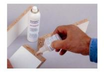
**Шаг 2.** На вторую деталь тонким слоем или точечно нанести клей.
